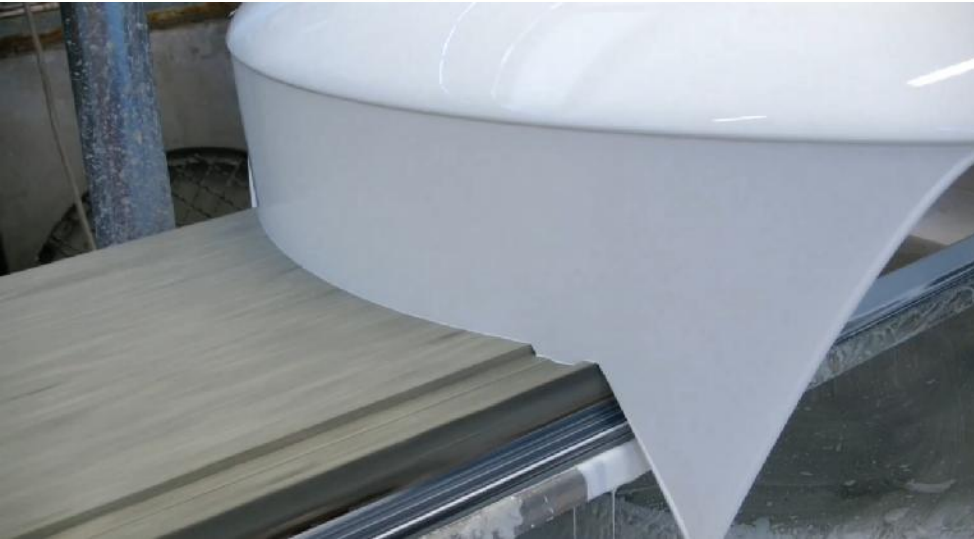
Telha de concreto sob aplicador por cortina de sino
